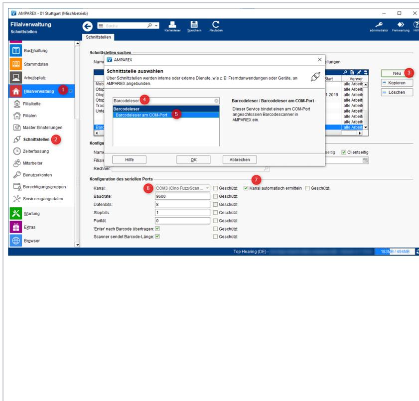
Als abschließenden Schritt muss der FUZZY Bluetoothscanner F78x in AMPAREX über eine Schnittstelle angemeldet werden.
