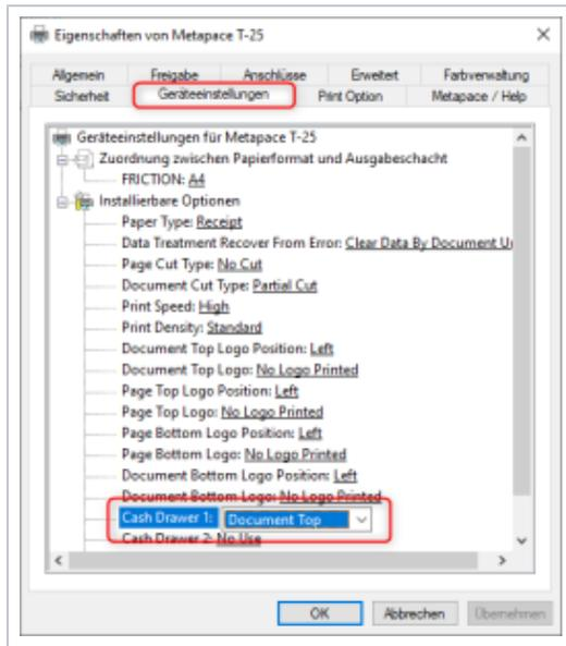
Wird an den Bondrucker eine Kassenschublade mit angeschlossen, muss in den Eigenschaften des Druckers im Reiter 'Geräteinstellungen' die Auswahl 'Document Top' im Eintrag 'Cash Drawer 1' ausgewählt werden
